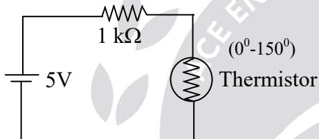
$$\text{At } 25^{\circ} \rightarrow 10\text{k}\Omega$$
