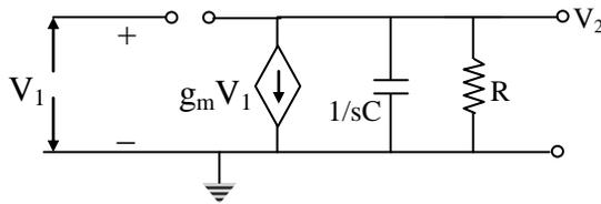
$$V_2 = -g_m V_1 (R // (1/sC))$$
