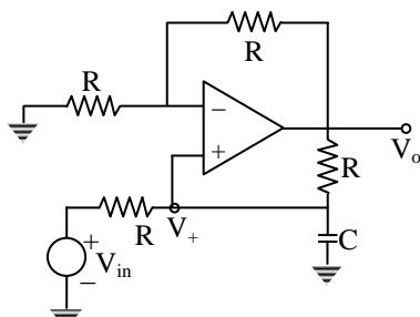
$$V_- = V_+ = \frac{V_o}{2}$$
