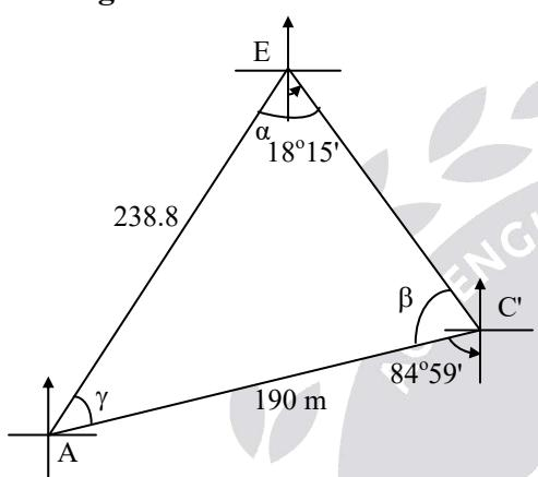
$$\beta = 180^\circ - 84^\circ 59' 4'' - 18^\circ 15' \\ = 76^\circ 45' 56''$$
