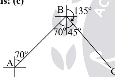
$$\angle B = 70^\circ + 45^\circ = 115^\circ$$
