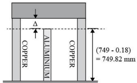
$$(La\Delta T)_a - \left( \frac{PL}{AE} \right)_a = (La\Delta T)_c + \left( \frac{PL}{AE} \right)_c + \Delta$$
