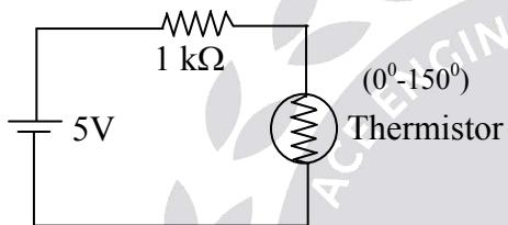
$$\text{At } 25^{\circ} \rightarrow 10\text{k}\Omega$$
