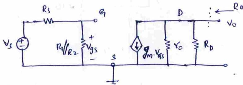
$$V_{GS} = \frac{R_1 // R_2}{(R_1 // R_2) + R_S} \cdot V_S$$
