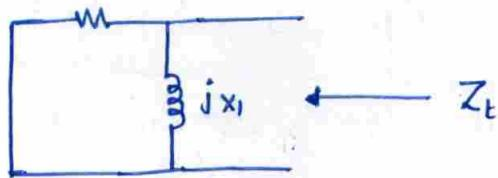
$$Z_t = \frac{R_1 (j X_1)}{R_1 + j X_1} = \frac{R_1 X_1^2 + j R_1^2 X_1}{R_1^2 + X_1^2}$$
