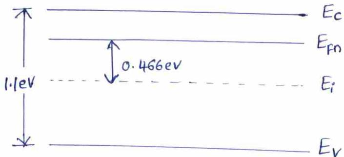
Fig. Band Diagram.
