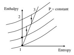
$$\begin{split} \eta_{\mathrm{ci}} &= \frac{T_2 - T_1}{T_3 - T_1} \\ \eta_{\mathrm{cp}} &= \frac{\sum \Delta T_i}{T_3 - T_1} \\ \Sigma \Delta T_i &> T_2 - T_i \\ \Rightarrow \eta_{\mathrm{cp}} &> \eta_{\mathrm{ci}} \end{split}$$
