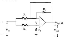
$$V_1 = \frac{R_3}{R_2 + R_3} \times V_{in}$$
