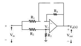
$$V_1 = \frac{R_3}{R_2 + R_3} \times V_{in}$$
