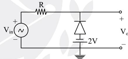
For  $V_i < -2V$ , Diode ON
