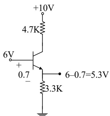
$$V_E = V_B - V_{BE} = 6 - 0.7 = 5.3V$$
