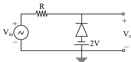
For  $V_i < -2V$ , Diode ON
