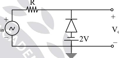
For  $V_i < -2V$ , Diode ON
