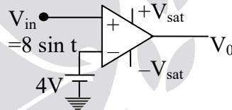
$$V_{in} > 4 \Rightarrow V_0 = +V_{sat}$$
